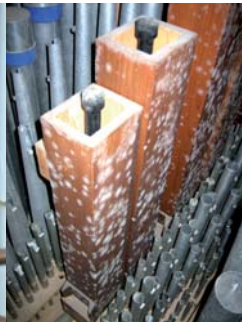
Rost und Schimmel setzen der Orgel zu
